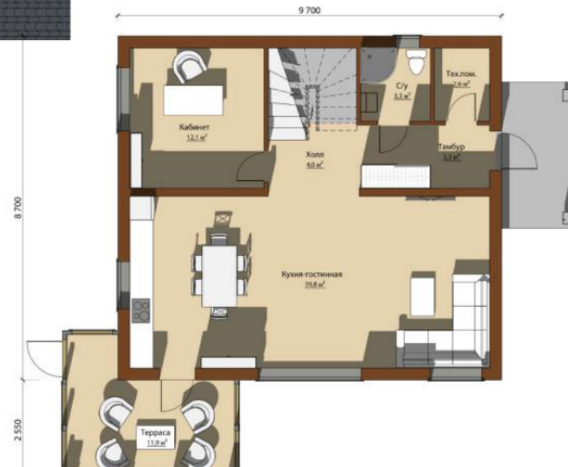
Экспликация помещения 1-й этаж
