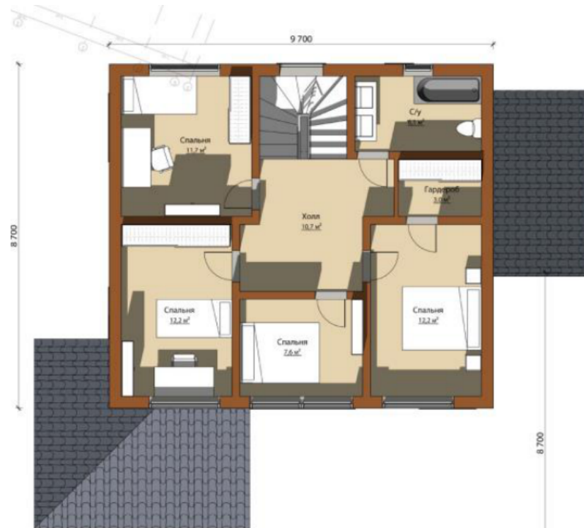
Экспликация помещения 2-й этаж
